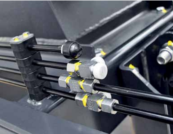
9: Montagesicherheit: Jede Verschraubung wird bei der Endmontage mit einer Farbe markiert
