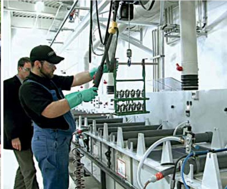
3: In der Versuchsgalvanik wird VOSS coat weiterentwickelt
