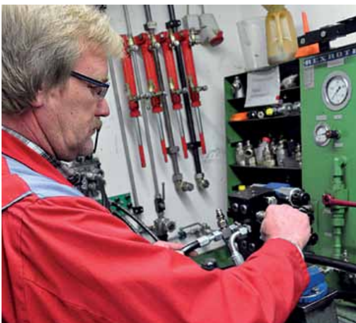
7: Thomas Gfell: „Der spürbare Kraftanstieg bei der Blockmontage mit dem VOSS-Schneidring ist wichtig, damit der Monteur weiß, dass er richtig montiert hat“
