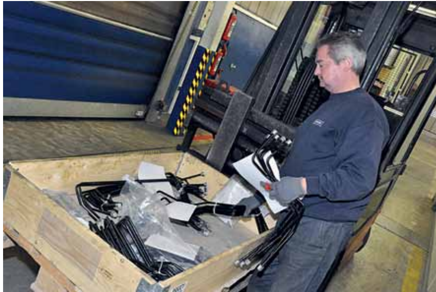
10: Die Hydraulikkomponenten kommen vormontiert an den jeweiligen Montageplatz der Fahrzeugproduktion
