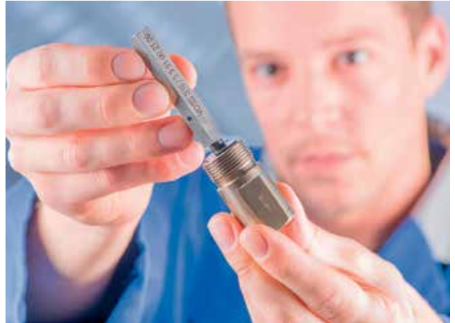
Qualitätssicherung nach der Fertigung: Ein Mitarbeiter von Voss Fluid kontrolliert den 24°-Konus am Stutzen. (© Voss Fluid)
