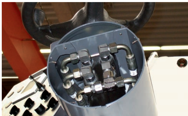
VOSS-Winkel-Verschraubungen mit Zink-Nickel-Oberfläche: umweltfreundlich und korrosionsbeständig.
