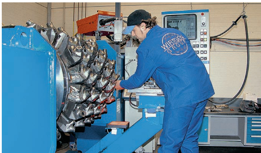
Fertigung bei Wirtgen: rechnergesteuerte Heftung und Verschweißung von Meißelhaltern.
