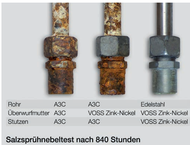
Systeme aus Rohr/Überwurfmutter/Stutzen in unterschiedlichen Werkstoffausführungen und Zusammenstellungen im Korrosions-Vergleich.
