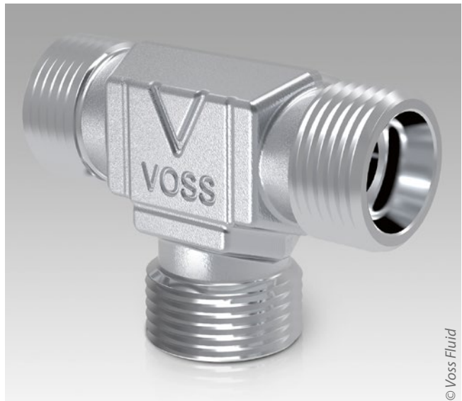
Rohrverbindung von Voss Fluid. Gegenüber dem marktgängigen Beschichten hat der Hersteller den Galvanisationsprozess hinsichtlich der Vermeidung von Bauteilbeschädigungen, Schichtverteilung, Optik und Reibbeiwerten optimiert.
