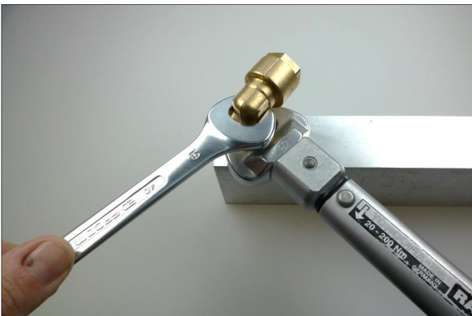
Abb. 9: Anziehen der Sechskantmutter mittels Drehmomentschlüssel
